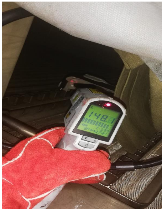
Figura 27: Medición de temperatura de molde de ULTEM 9085 dentro del horno de calentamiento.
