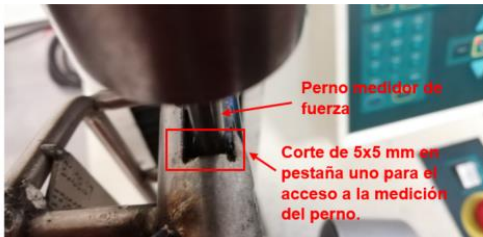
Figura 20: Corte de 5x5 mm en pestaña 1 de molde de acero inoxidable
