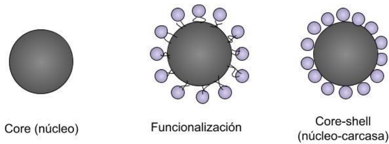
Figura 29. Superficie funcionalizada de una molécula magnética recubierta por un compuesto orgánico.
