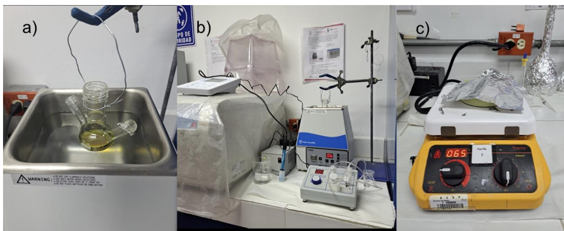
Figura 4. (a) Tratamiento ultrasónico; (b) ajuste de pH y reacción ultrasónica; (c) secado del material.
