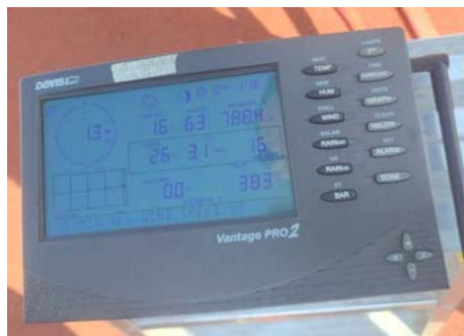
Figura 4.11. Consola de registro de variables atmosféricas e irradiancia.
