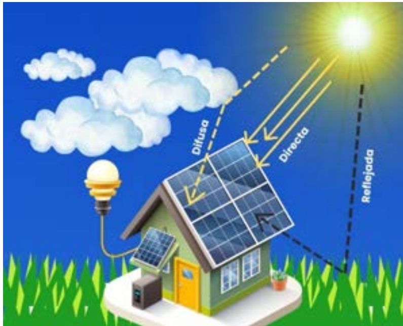
Figura 2.1. Componentes de la irradiancia solar: directa (rayos solares sin dispersión), difusa (radiación desviada por la atmósfera) y reflejada (fracción de la radiación reemitida por la superficie terrestre).
