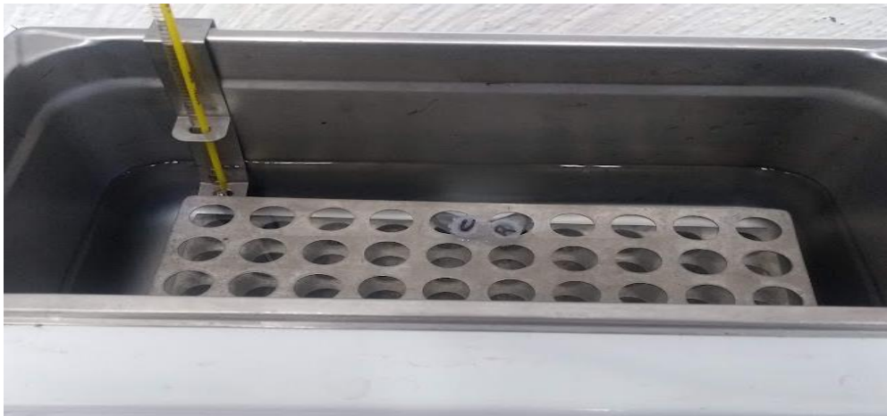
Figura 10. La desvitrificación de las muestras de espermatozoides se realizó al incubar las perlas con el medio CZB en Baño María a 37° por 5 minutos.
