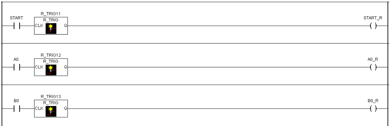
Figura 4.1.10 Diagrama de Escalera de las condiciones de transición parte 1.
