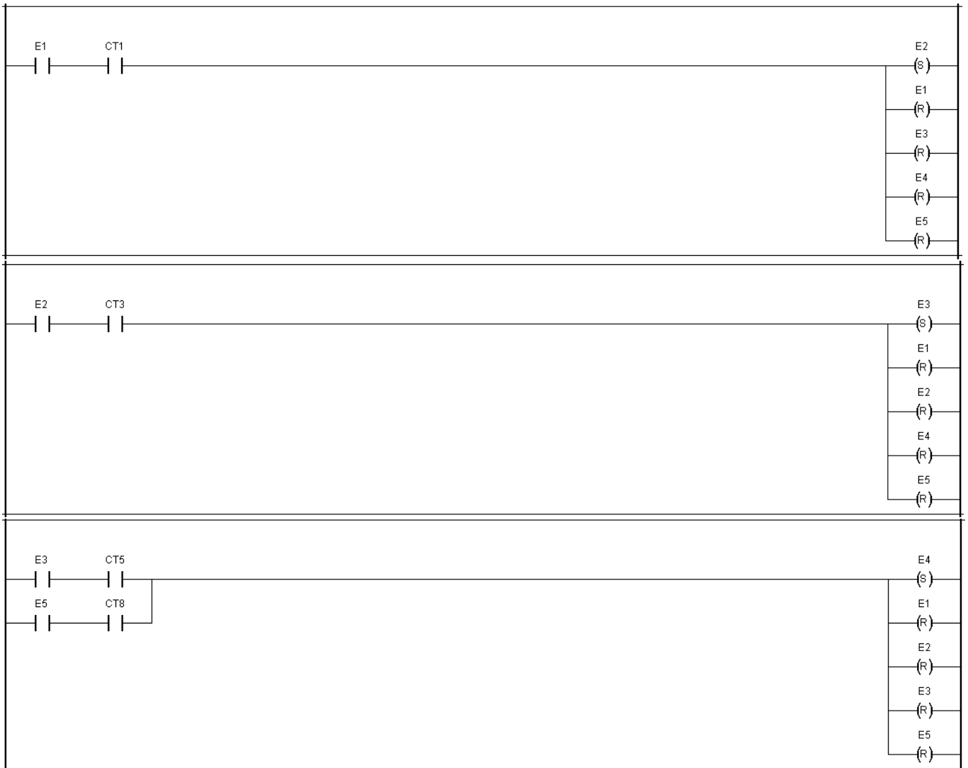
Figura 6.1.23 Activación de los estados del automatismo parte 1.
