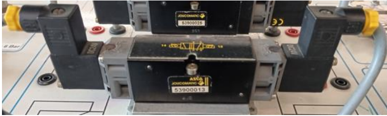
Figura 6.2.3 Válvulas de control de 5/2 vías del laboratorio de neumática.
