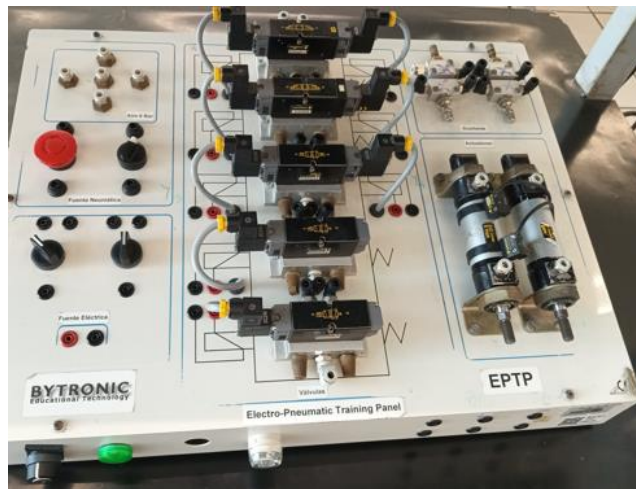
Figura 6.2.4 Tablero de entrenamiento electroneumático del laboratorio de neumática.
