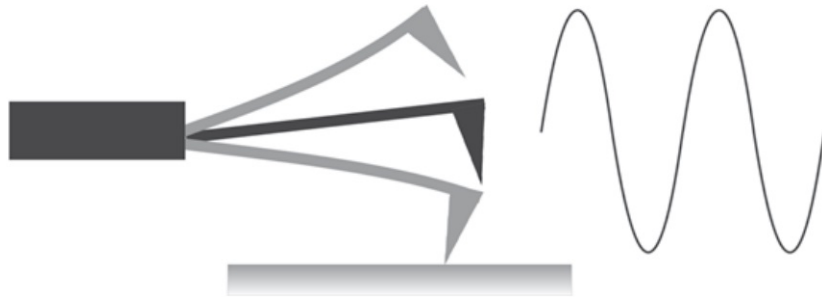
Figura 1.17. Movimiento que describe la punta del AFM en el modo de contacto intermitente [55].
