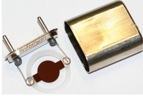
Figura 1.6. QCM de 8 MHz y su cubierta [41].
