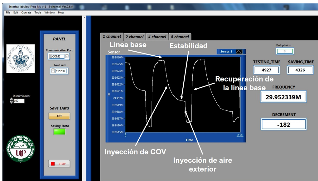
Figura 2.15. Interfaz del software para visualizar y medir la respuesta del sensores QCM a COVs. Se aprecia la curva de respuesta del sensor QCM_41 a los tres volúmenes de etanol: 5, 10 y 15 \mu L.
