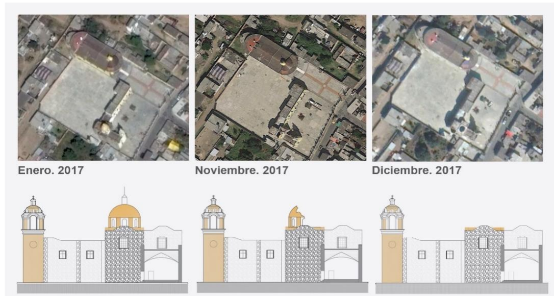
Imagen 4. Imágenes satelitales del templo en el que se observa el espacio de la cúpula antes del sismo, a dos meses del sismo y a tres meses del desastre. Elaboración propia. 2023.
