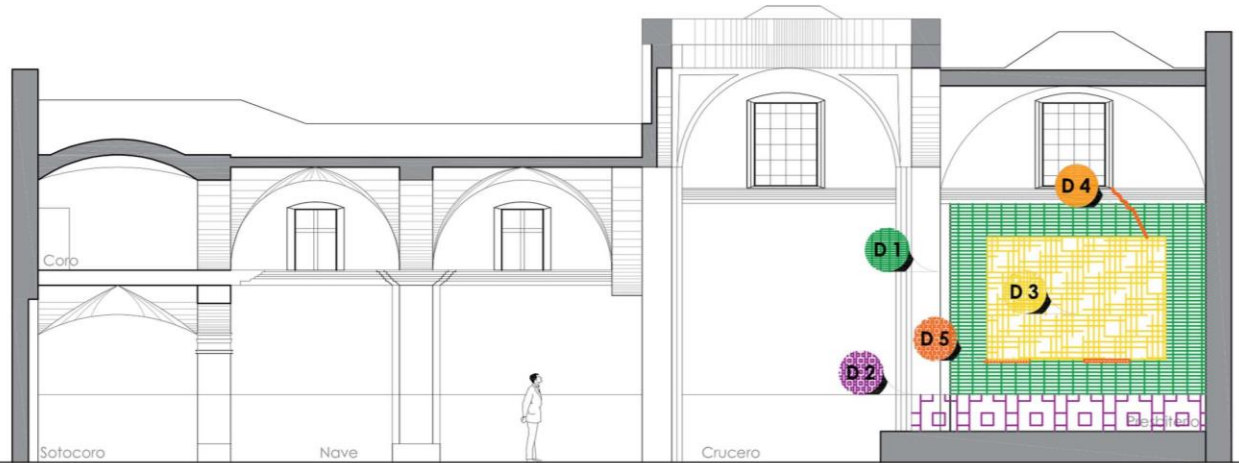
Imagen 4. Deterioros en lienzo en pared en el ábside.
