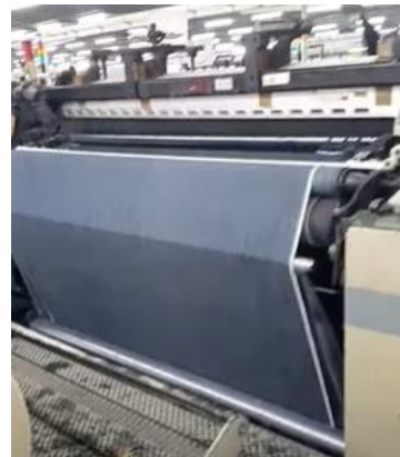
Figura 38: Presentadora electrónica y telar en producción
