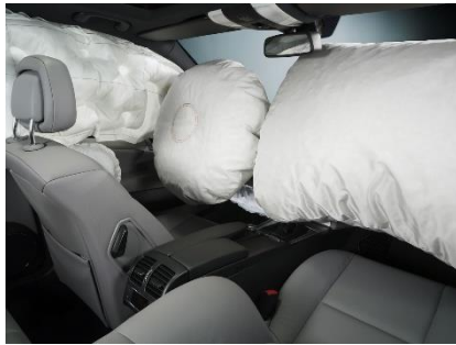
Figura: 52 Funcionamiento de las Air-Bag
