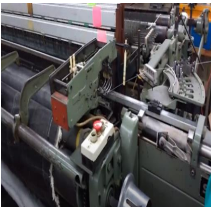
Figura 38: Presentadora electrónica y telar en producción
