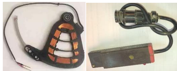
Figura 47: Presentadora electro-magnética y sensor inductivo de posición de máquina
