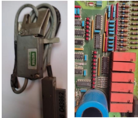
Figura 25: Sensor y tarjeta de control del sistema de purgado
