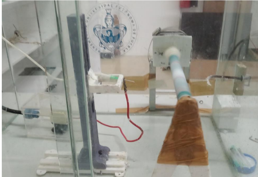
Figura 12. Equipo de Electrohilado: Proceso de hilado de membrana.
