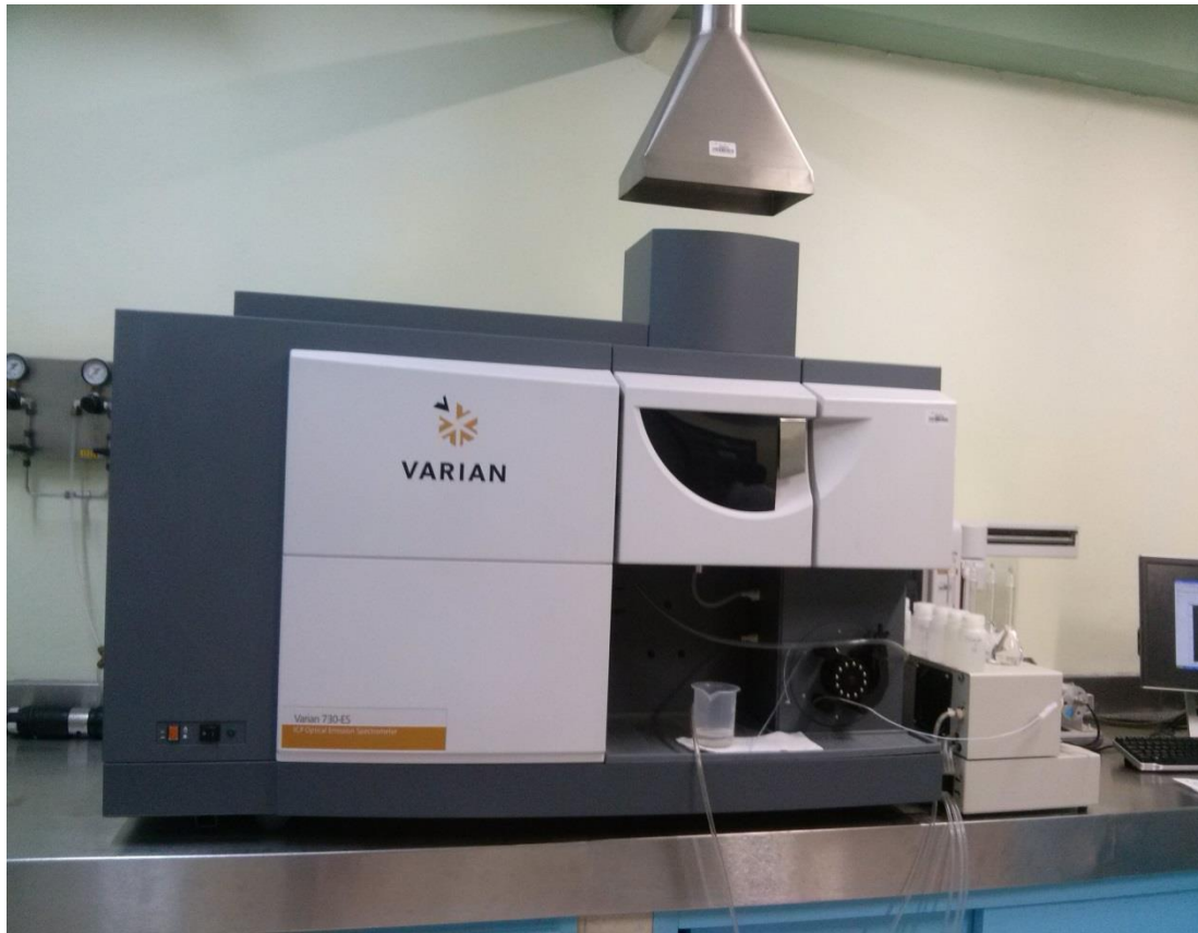
Figura 2.8 Cuantificación de muestras de As en el equipo ICP-MS
