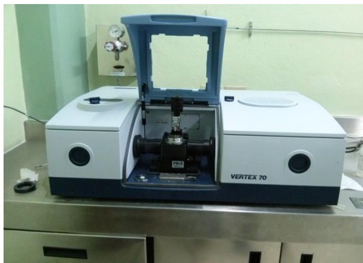
Figura 2.5 Espectroscopia de Infrarrojo Transformada de Fourier.
