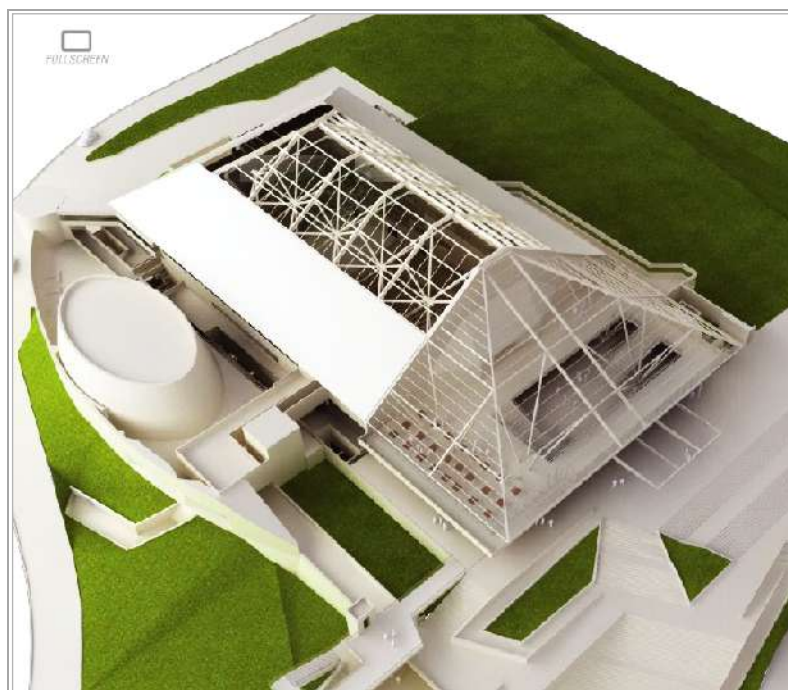
Estructura y cubierta en caja de música y vestíbulo
