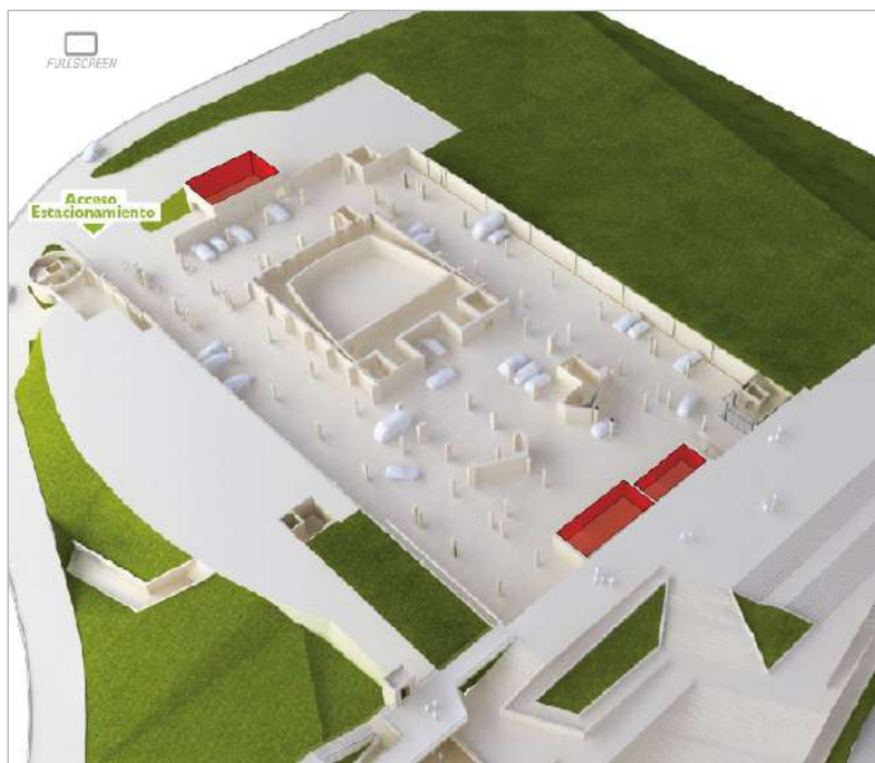
Localización de Unidades Manejadoras de Aire, alejadas de la caja acústica.
