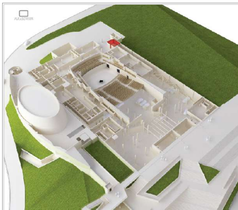
Anden de carga y descarga, anexo y en el mismo nivel que las Salas de ensayo
