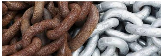
Figura 2. Corrosión en un metal.
