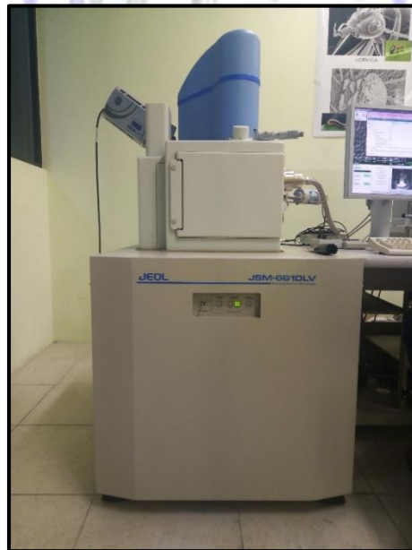
Figura 19. Microscopio Electrónico de Barrido marca JEOL modelo JSM-6610LV.
