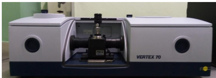
Figura 18. Espectrofotómetro marca Bruker modelo VERTEX 70.
