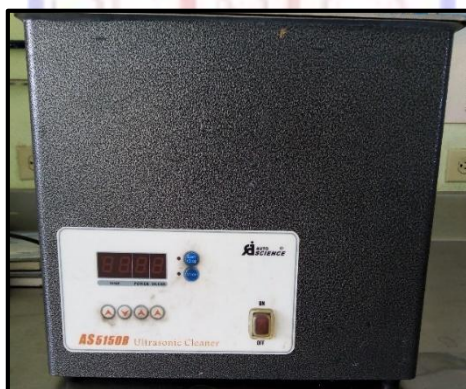
Figura 15. Baño de ultrasonido modelo AS5150B de la marca AUTO SCIENCE.
