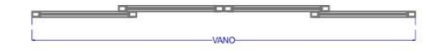
PUERTA CORREDIZA DE CRISTAL TEMPLADO DE 9MM ESMERILDO CON CERRADURAS DE ACERO INOXIDABLE
