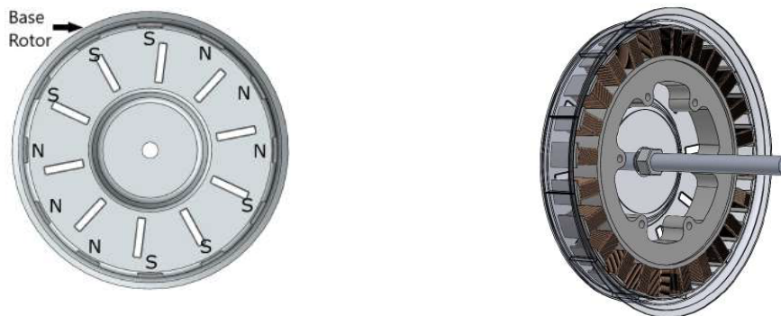
Figura 2.3: Ensamble del rotor con el estator nor permite conformar el motor trifásico de imanes permanentes tipo Brushless [8]. (a) Distribución y polaridades de los imanes permanentes del rotor. (b) Ensamble del rotor y el estator del motor con su respectivo eje.
