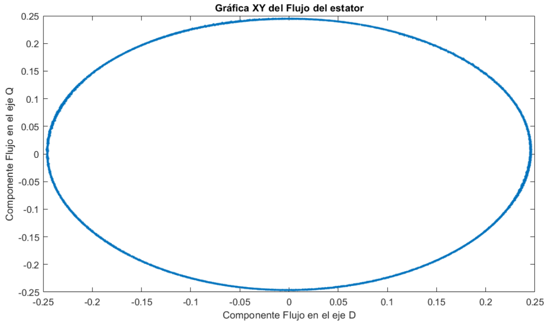
Figura 7.11: Gráfica de la trayectoria del flujo del estator.
