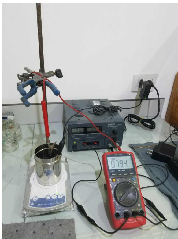
Figura 9. Sistema galvanostático empleado para la reacción de electrodesaminación.
