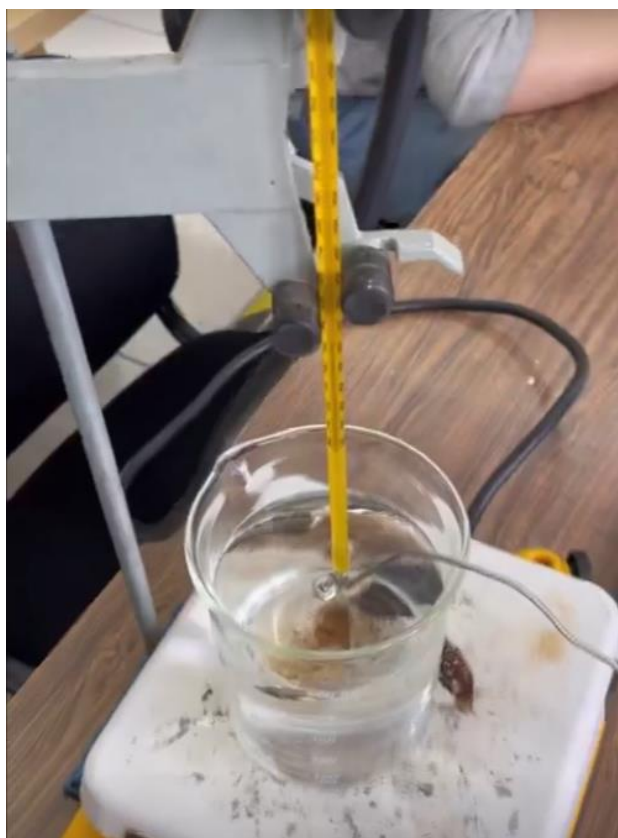
Figura 12. Foto de la prueba de termómetro mercurio vs termopar
