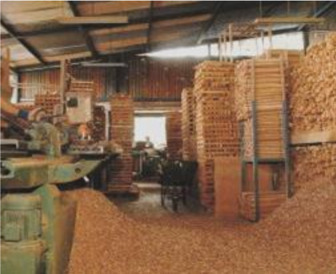
Foto 17: Aserrín en el suelo obstruye paso y aumenta riesgo de accidentes
