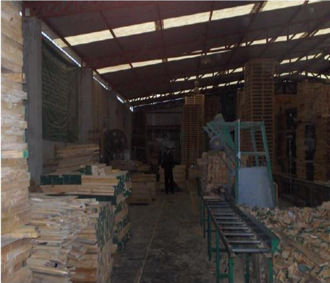
Foto 11: En esta fotografía se aprecia cómo no se respetan los espacios aunque exista una línea divisoria amarilla.
