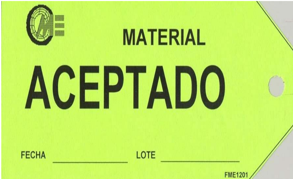
Figura 14. Etiqueta de material conforme
