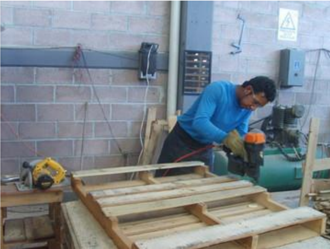
Foto 7: Reparación de tarimas
