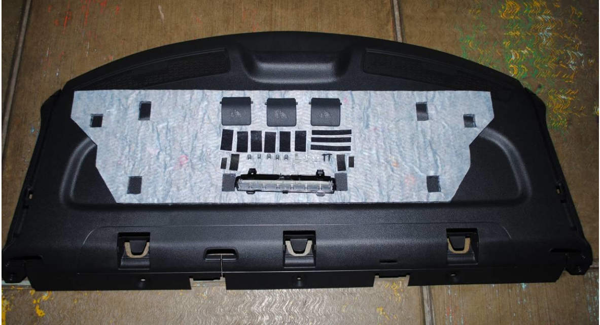
Fotografía 10. Componentes de la sombrerera de polipropileno
