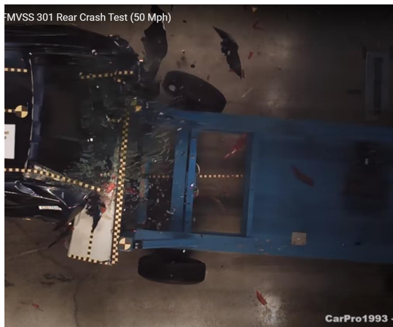
Fotografía 11. Prueba crash trasero según norma FMVSS301 (CarPro, 2019)
