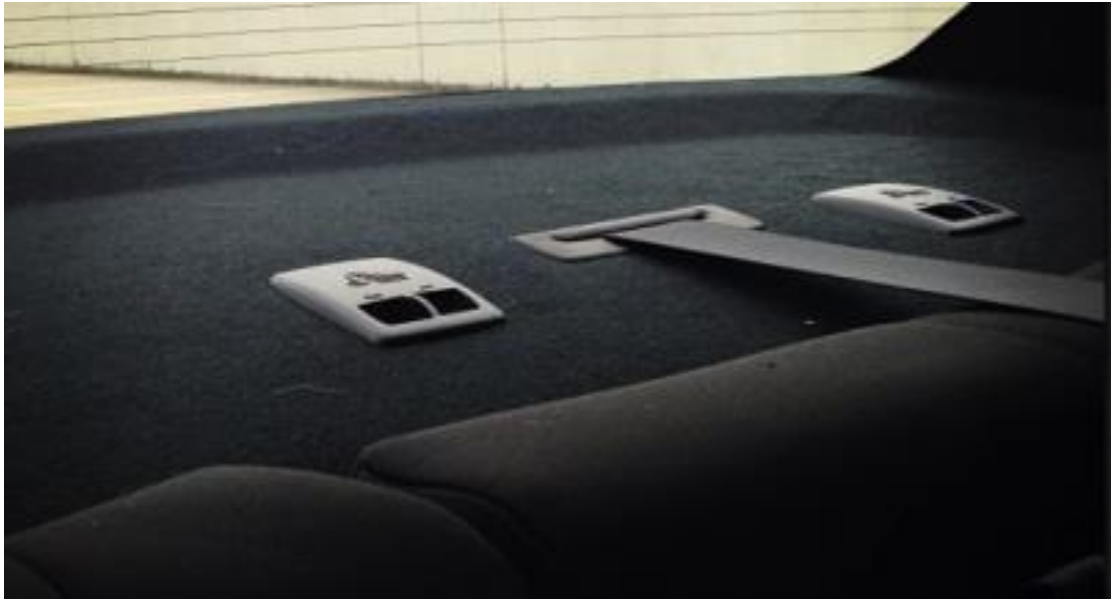
Fotografía 3. Sombrerera con cinturón de seguridad y anclajes.
