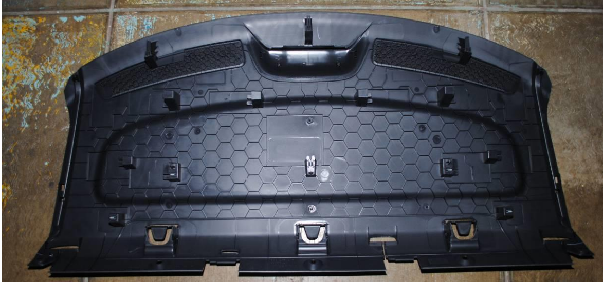
Fotografía 8. Refuerzo estructural por medio de celdas de panal para proporcionar rigidez y resistencia.
