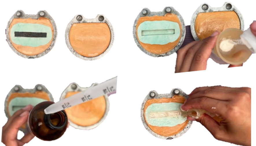
Fig. 18 Elaboración del molde y de las barras de PMMA autopolimerizable.
