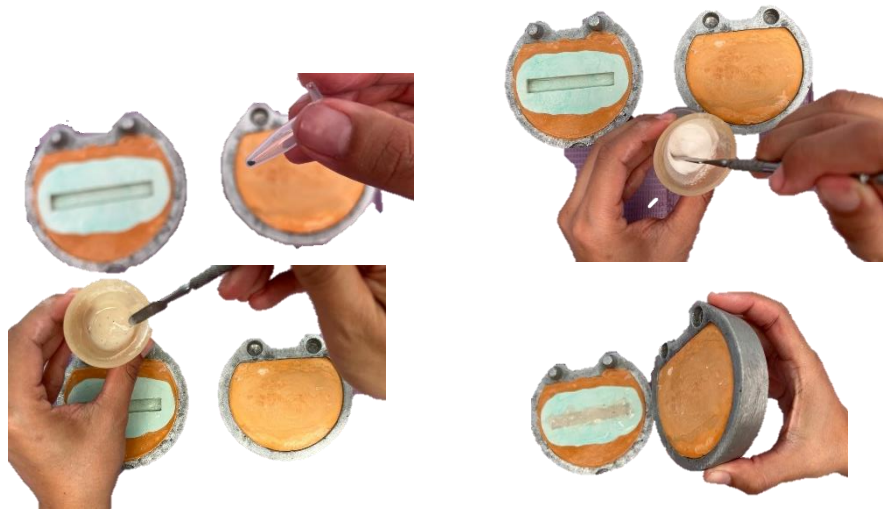
Fig.19 Procedimiento de elaboración de las barras de PMMA autopolimerizable modificadas con óxido de grafeno.
