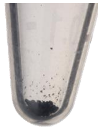
Fig. 4 Tubo Eppendorf con óxido de grafeno.
