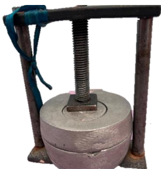
Fig. 20 Mufla cerrada a presión con prensa metálica.
