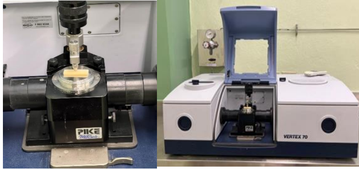
Fig. 28 Prueba de FT-IR mediante espectrofotómetro Vertex 70.
