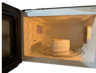
Fig. 15 Mufla con mezcla en el molde para termopolimerización en microondas.
