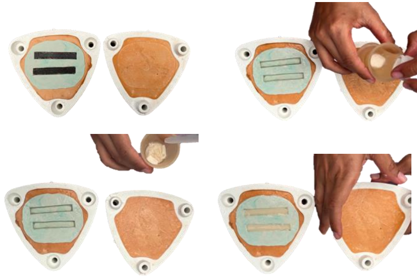
Fig.11 Elaboración del molde y de las barras de PMMA termopolimerizable.
