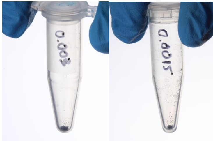
Fig. 12 Tubos Eppendorf con óxido de grafeno en proporciones de 0.003gr y 0.0015gr.
