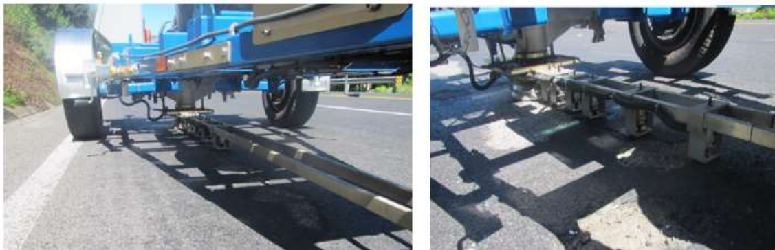
Figura 12.- Geófonos o sensores de deformación (BUAP, 2018)
