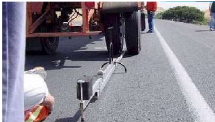
Figura 7.- Viga Benkelman (BUAP, 2018)
