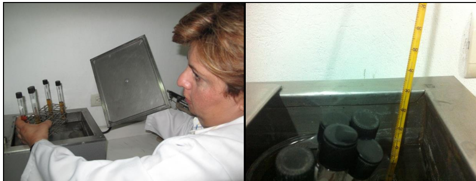
Incubación de tubos de caldo EC (prueba confirmativa de CF realizada a 44.5°C)
