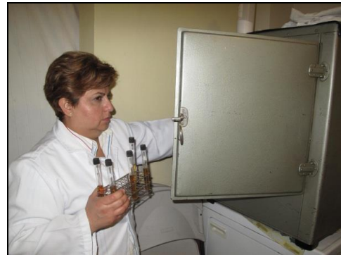
Incubación de los tubos de caldo lauril sulfato de sodio (prueba presuntiva de CF)
