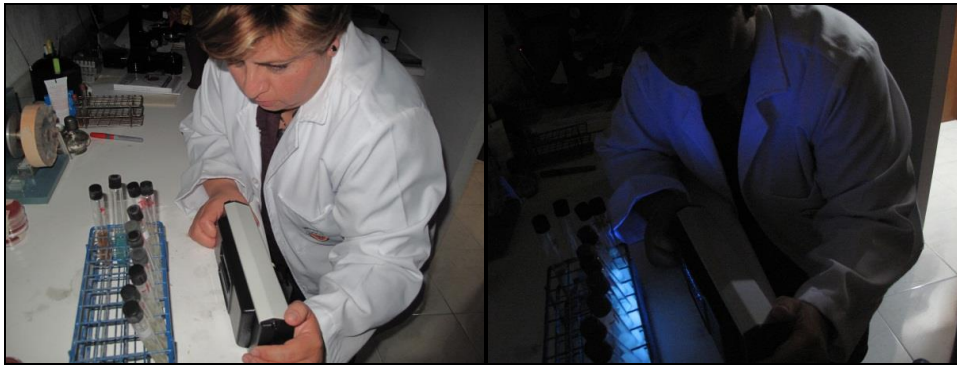
Uso de la lámpara de luz UV para evidenciar fluorescencia en caldo EC con MUG (prueba positiva de coliformes fecales)
