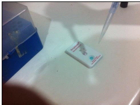
Inoculación del cartucho para la identificación de Salmonella sp (prueba rápida)
