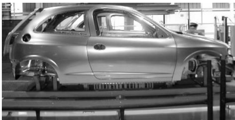
Figura 18. Imagen de una carrocería al iniciar el pre tratamiento de pintura.
