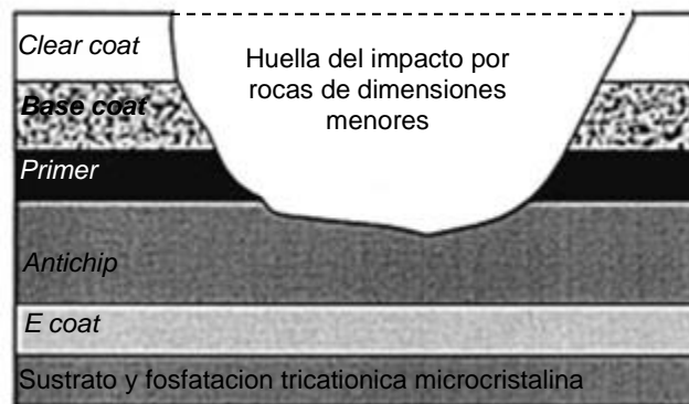
Figura 26. Remoción de pintura por picadura de partículas solidas.
