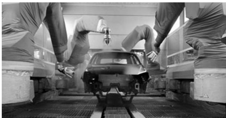
Figura 22. Aplicación de la capa de PVC (Antichip) [105].
