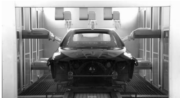
Figura 24. Aplicación de la base coat [105].
