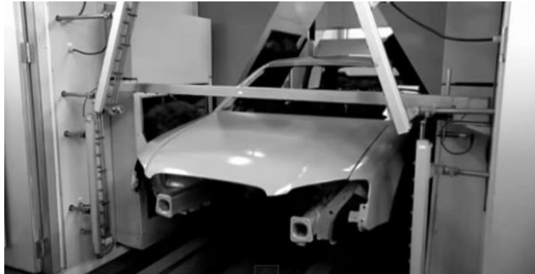
Figura 23. Marco electrostático utilizado para eliminar polvo [105].
