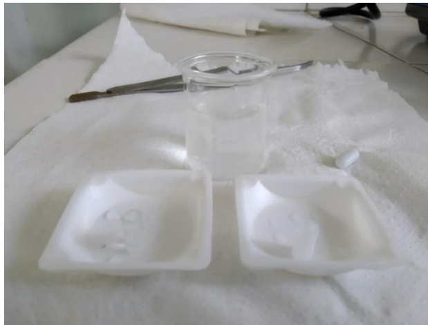
Figura 19. Anillos Raschig con una sola impregnación (Derecha) y doble impregnación (Izquierda) después de ser sometido a agitación constante en agua desionizada.
