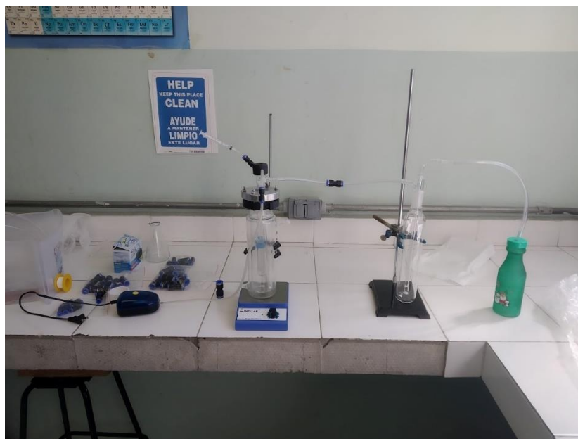
Figura 14. Reactor, servicios auxiliares y trampa de gases.
