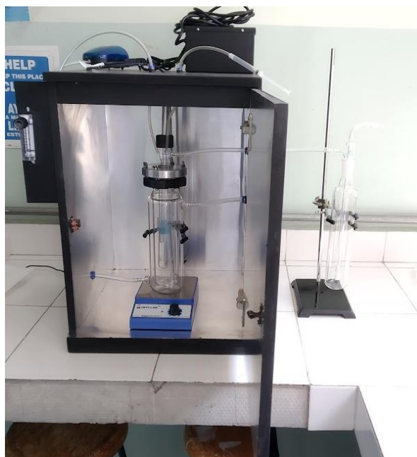
Figura 16. Estación de fotocátalisis terminada.
