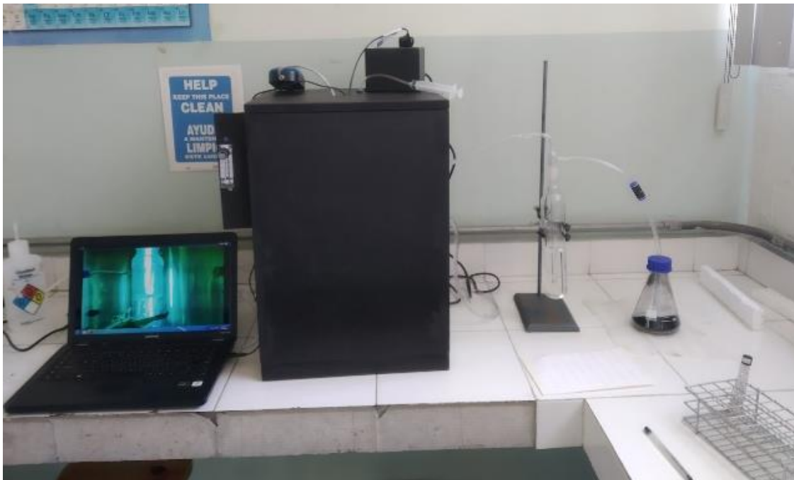
Figura 47. Estación de fotocátalisis completa operando durante el experimento de fotolisis del ibuprofeno en medio acuoso.
