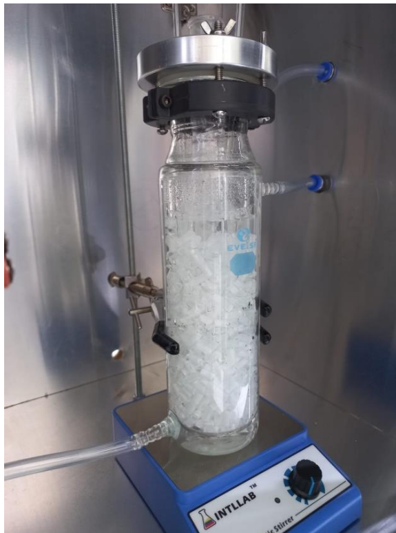
Figura 30. Fotorreactor estilo torre empacada.
