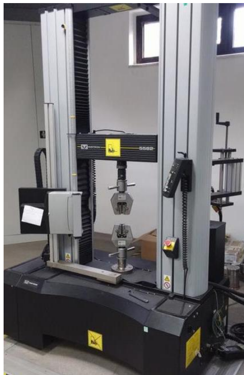
Figura 6. Equipo para pruebas mecánicas (tensión/deformación)
