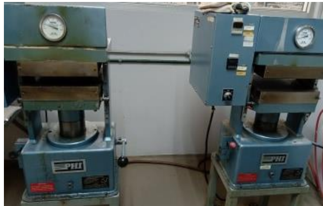
Figura 17. Prensas hidráulicas para la elaboración de las láminas.
