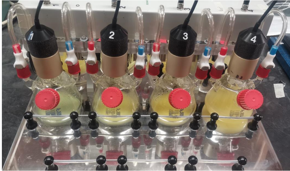
Fig. 14 Equipo RAMOS. Ensayos realizados con P. protegens EMM-1 a 23°C y 100 rpm.
