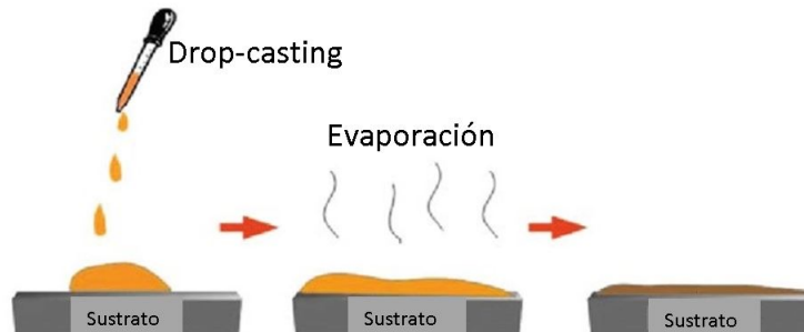
Figura 2.12. Método de depósito de películas por drop-casting [19].
