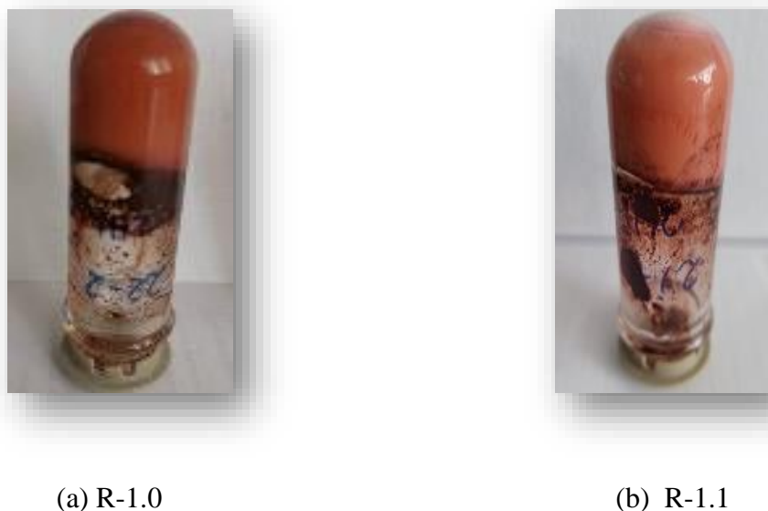
Figura 19. Apariencia de los geles de las series R-1.0 y R-1.1 después de 24 horas de exposición a 160 °C.
