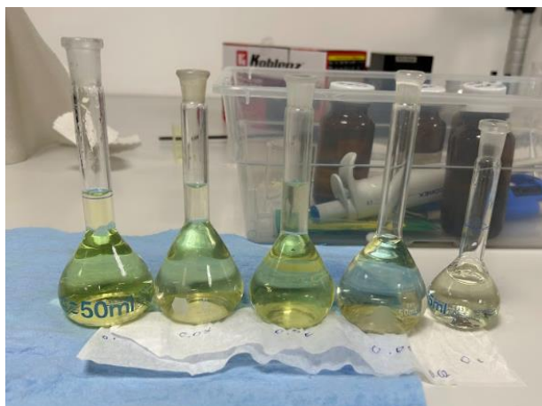
Figura 3.4. Soluciones estándar de 4-NP a diferentes concentraciones para la curva de calibración.
