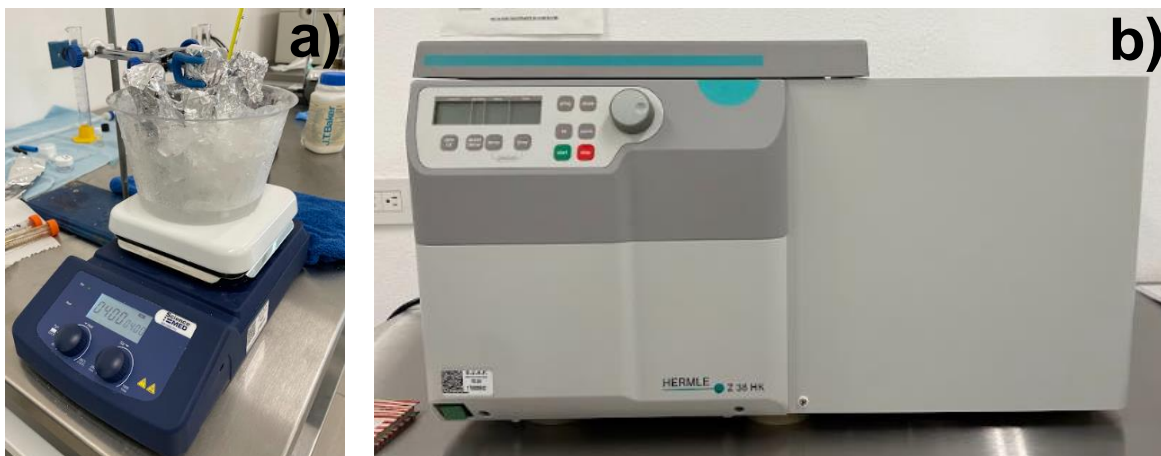
Figura 3.1. Equipos utilizados a) Parrilla de calentamiento con agitación magnética para la redispersión de NpsAg (CORNING PC 420D) b) Centrifuga HERMLE Z36K con capacidad de 25,000 rpm para el lavado de NpsAg.
