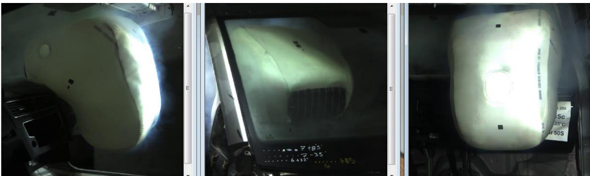
Figura 25. Ejemplo de video-registros de la prueba estática de la bolsa de aire del pasajero
