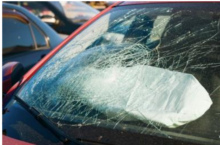
Figura 22. Parabrisas rotos por bolsas de aire del pasajero
