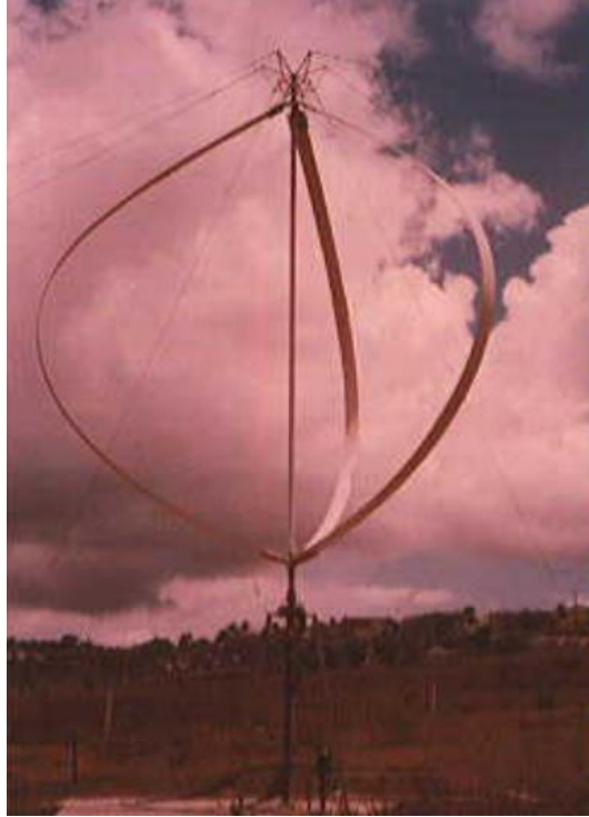
Figura 24 Turbina de eje vertical Darrieus Fuente: Vázquez, M. Diseño de una turbina eólica de eje vertical con rotor mixto. (2007).
