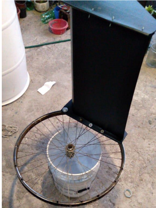
Figura 51 Ensamble de un alabe al rin de bicicleta Fuente: Grupo de tribología y transporte. Facultad de Ingeniería. Benemérita Universidad Autónoma de Puebla. ANSYS 2020 R2. (2022).
