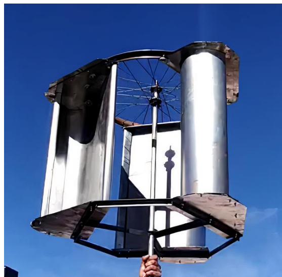
Figura 52 Ensamble principal de la VAWT Darrieus tipo H Fuente: Grupo de tribología y transporte. Facultad de Ingeniería. Benemérita Universidad Autónoma de Puebla. ANSYS 2020 R2. (2022).
