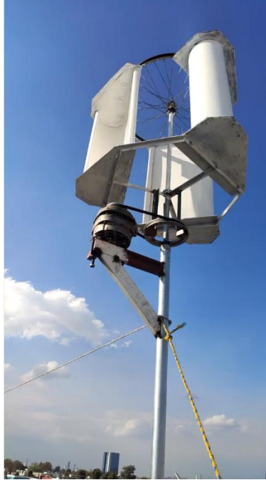
Figura 54 VAWT Darrieus tipo H Fuente: Grupo de tribología y transporte. Facultad de Ingeniería. Benemérita Universidad Autónoma de Puebla. ANSYS 2020 R2. (2022).
