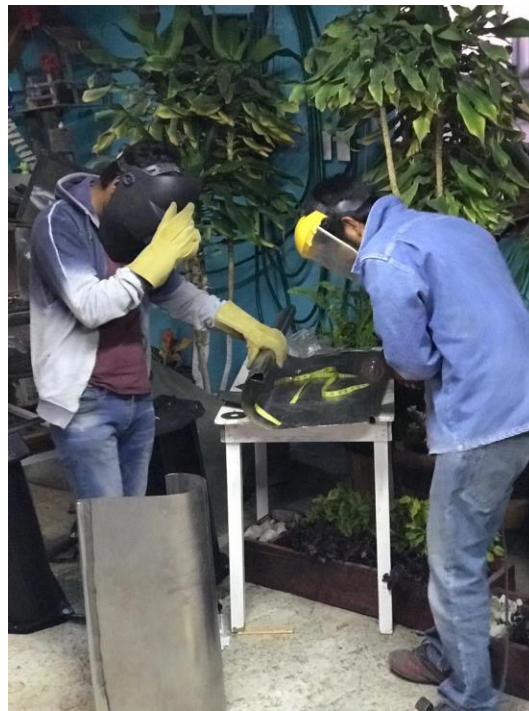
Figura 50 Manufactura de las palas de la turbina Fuente: Grupo de tribología y transporte. Facultad de Ingeniería. Benemérita Universidad Autónoma de Puebla. ANSYS 2020 R2. (2022).
