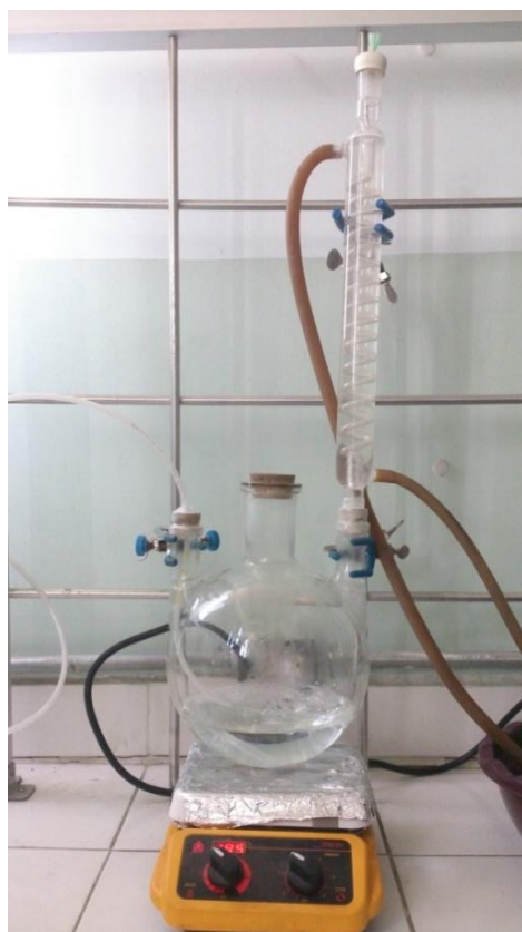
Figura 2.1. Preparación de agua decarbonatada.
