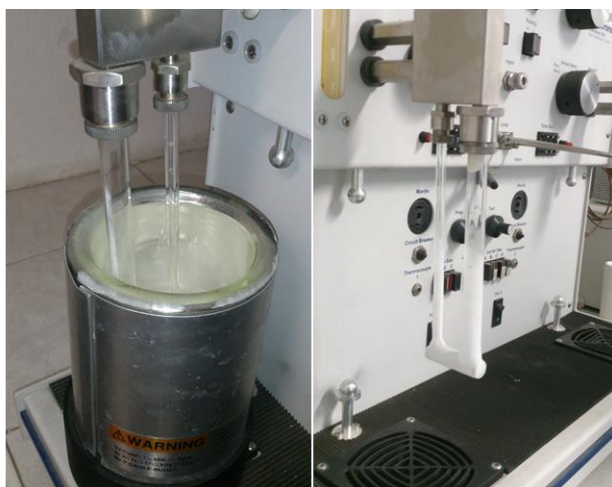
Figura2.8. Uso de nitrógeno líquido para la obtención del volumen de \text{N}_2 fisisorbido en la superficie del material.
