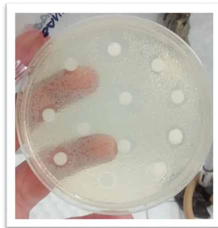
Figura 4. Reto microbiano con dióxido de cloro vs. E. coli ATCC 8739
