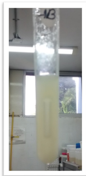
Figura 22. Prueba confirmativa en caldo EC para coliformes totales
