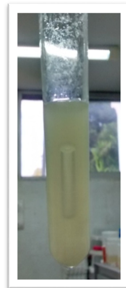
Figura 23. Prueba confirmativa en caldo caldo EC para coliformes fecales
