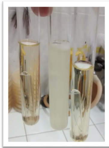
Figura 20. Prueba para coliformes totales en caldo lauril triptosa
