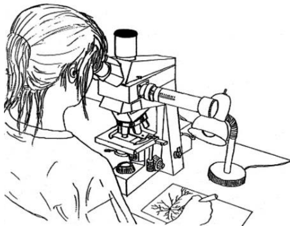
Figura 15. Microscopio con cámara lúcida. Con la superposición óptica de la neurona en el microscopio, se realiza el dibujado de neuronas para una recreación exacta.
