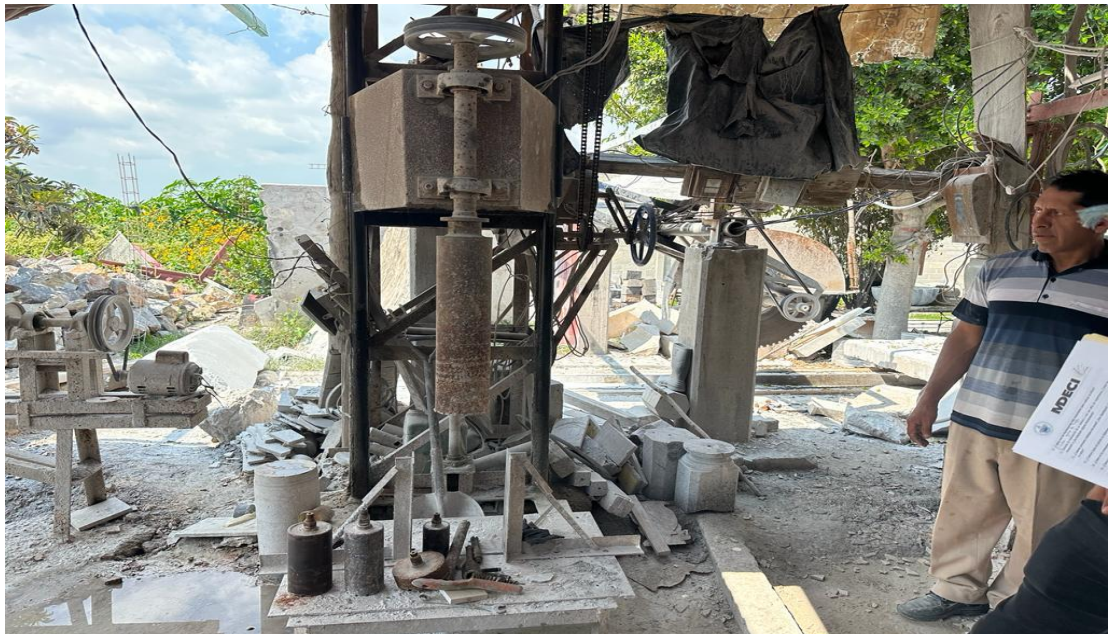
Foto 10. Perforadora artesanal elaborada localmente
