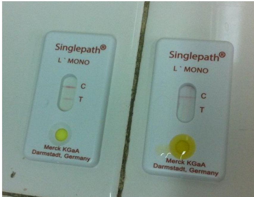
Fotografía 26. Prueba de detección rápida de L.monocytogenes positiva para la cepa control (izquierda) y negativa para la cepa presuntiva de Listeria sp. (derecha).
