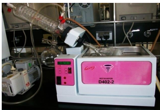
Figura 4. Extracción del solvente del nanocatalizador.
