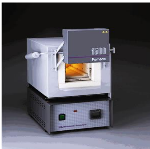
Figura 6. Tratamiento térmico de los nanocatalizadores.
