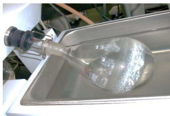
Figura 4. Extracción del solvente del nanocatalizador.
