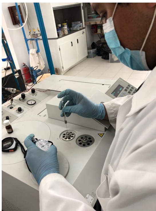
Figura 14. Inyección de endosulfán
