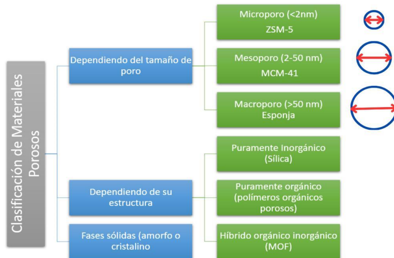
Figura 5. Clasificación de materiales porosos de acuerdo con su tamaño de poro
