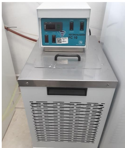
Figura 3.4 Recirculador de agua para mantener constante la temperatura a 25 °C en el reactor.
