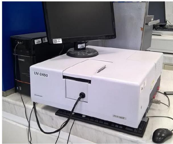
Figura 3.6 Espectrofotómetro UV-Vis modelo 2450 Shimadzu con esfera de integración.
