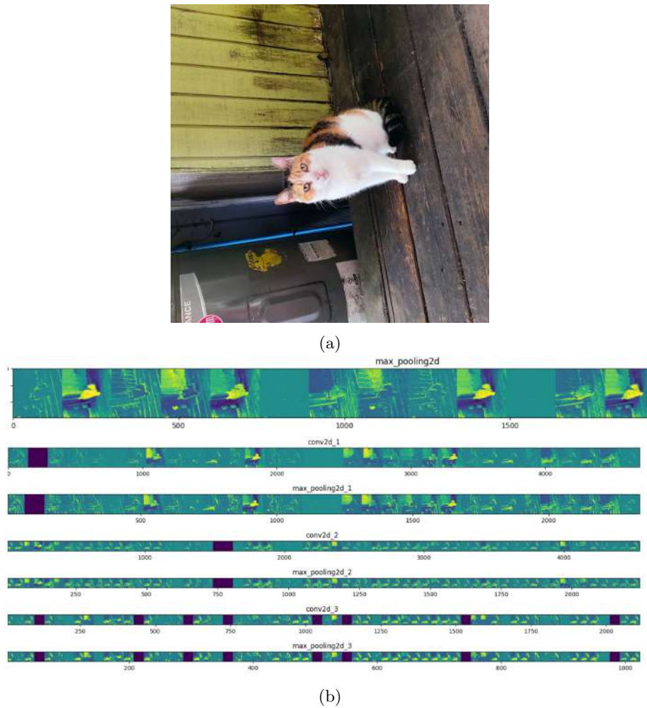
Figura 1.15: Procesamiento de una imagen en una CNN: a) imagen de entrada y b) resultado del procesamiento de la imagen después de atravesar una capa de convolución o de pooling.
