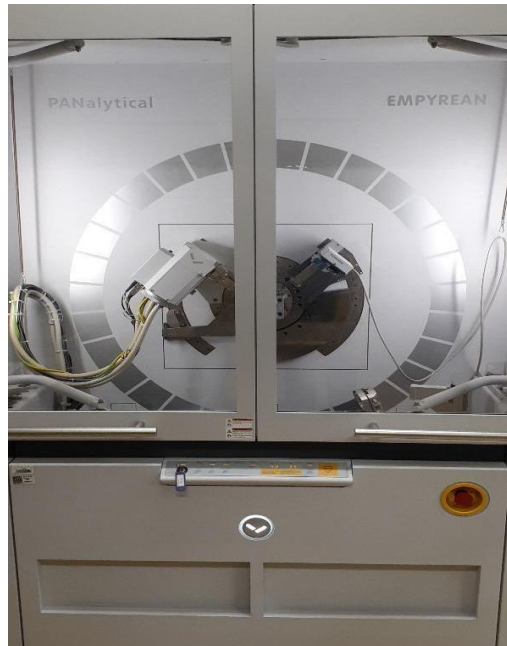
Figura 11. Difractómetro de rayos X utilizado para medir las muestras. (Laboratorio de Cristalografía del Instituto de Física, BUAP).
