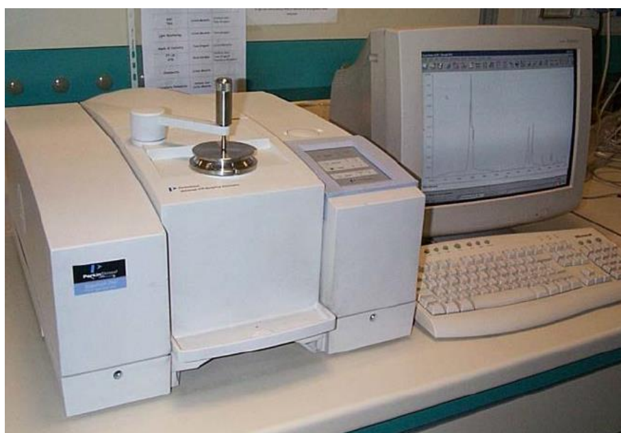
Figura 8. Espectrofotómetro infrarrojo FTIR-ATR utilizado para medir las muestras. (Laboratorio de Análisis Instrumental, Facultad de Ingeniería Química, BUAP).
