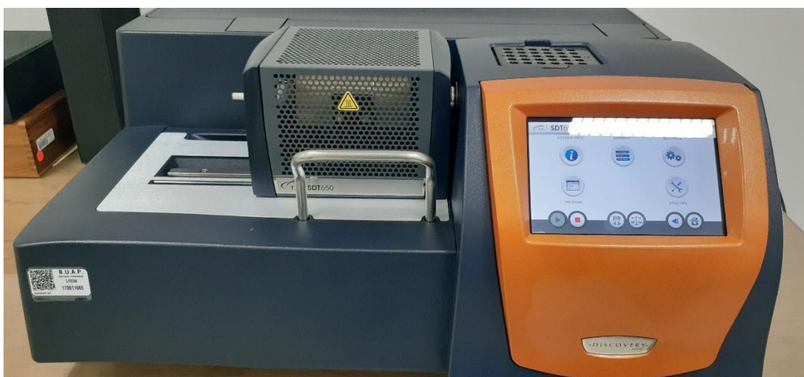
Figura 6. Analizador Calorimétrico simultáneo SDT 650 empleado para medir las muestras. (Laboratorio Central del Instituto de Física, BUAP).
