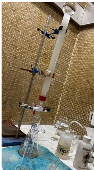
Figura 4. Sistema de purificación de columna cromatografica para el monómero 4-AcBz
