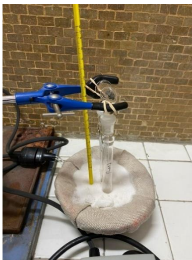
Figura 6. Equipo de montaje para la polimerización del monómero 4-AcBz
