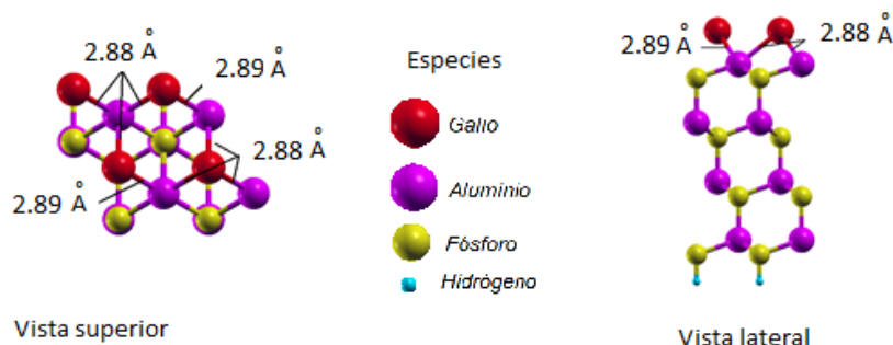
Figura 3.2: Superficie ALP(111) con una monocapa de Ga en la posición H3.
