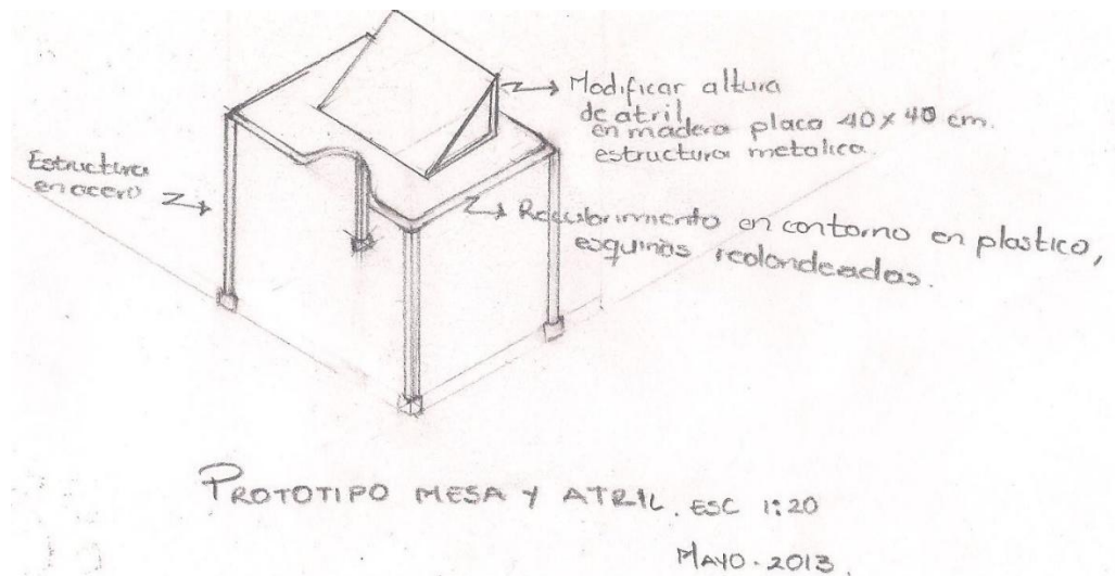
Imagen 95. Prototipo de mesa y atriil para Centros de Atención Múltiple.
