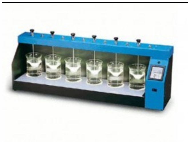
Fig. 3.1.- Equipo de jarras para pruebas de coagulación-floculación y sedimentación.
