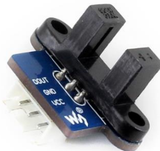
Figura 3.8. Foto sensor utilizado para medir la velocidad [25].
