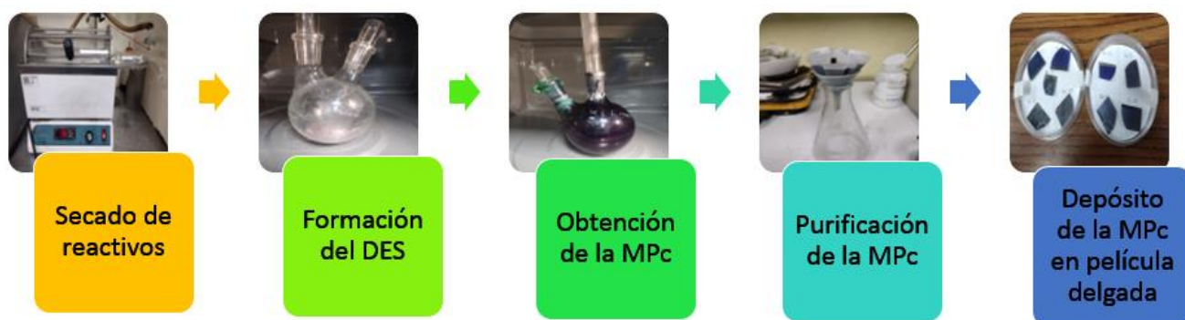
Figura 3.2 Diagrama esquemático del proceso de síntesis de MPcs.
