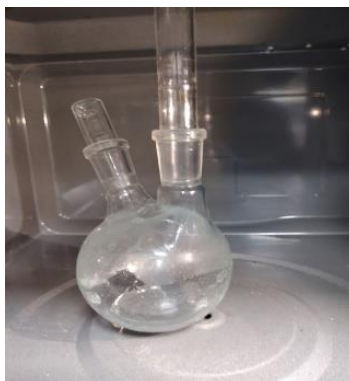
Figura 3.5 Obtención del Solvente Eutéctico Profundo a base de urea y glicerina.
