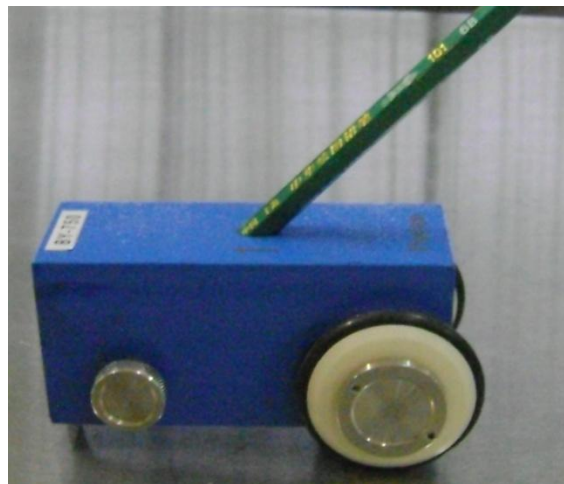
Figura 23. Dispositivo utilizado para llevar a cabo la prueba de rayado.
