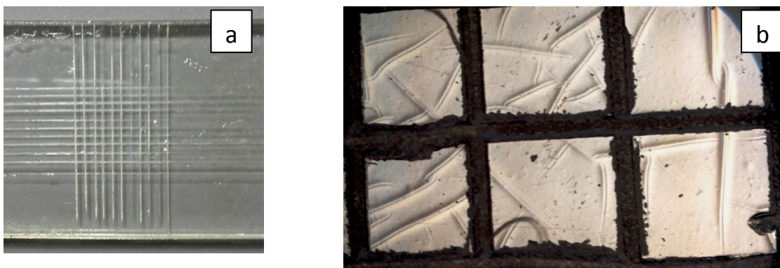
Figura 38. (a) Recubrimiento híbrido curado por tratamiento térmico (b) Amplificación de la muestra después de ser sometida a la prueba de adhesión.
