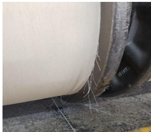
Figura 29. Hilos de urdimbre con orilla enterrada.
