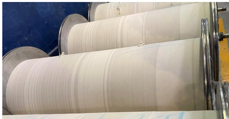
Figura 14. Julios con hilo rayados (defectuoso).
