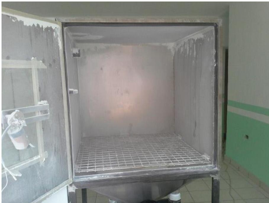
**Figura 3.1 b)** Marcha blanca de la cámara de pruebas.
