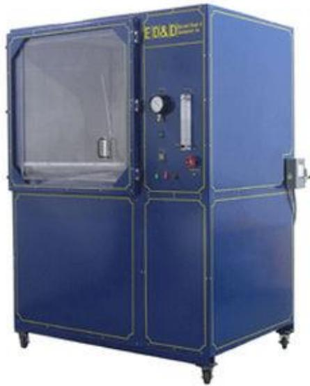
**Figura 1.2** Cámaras de prueba de estanqueidad al polvo DTC Series.
