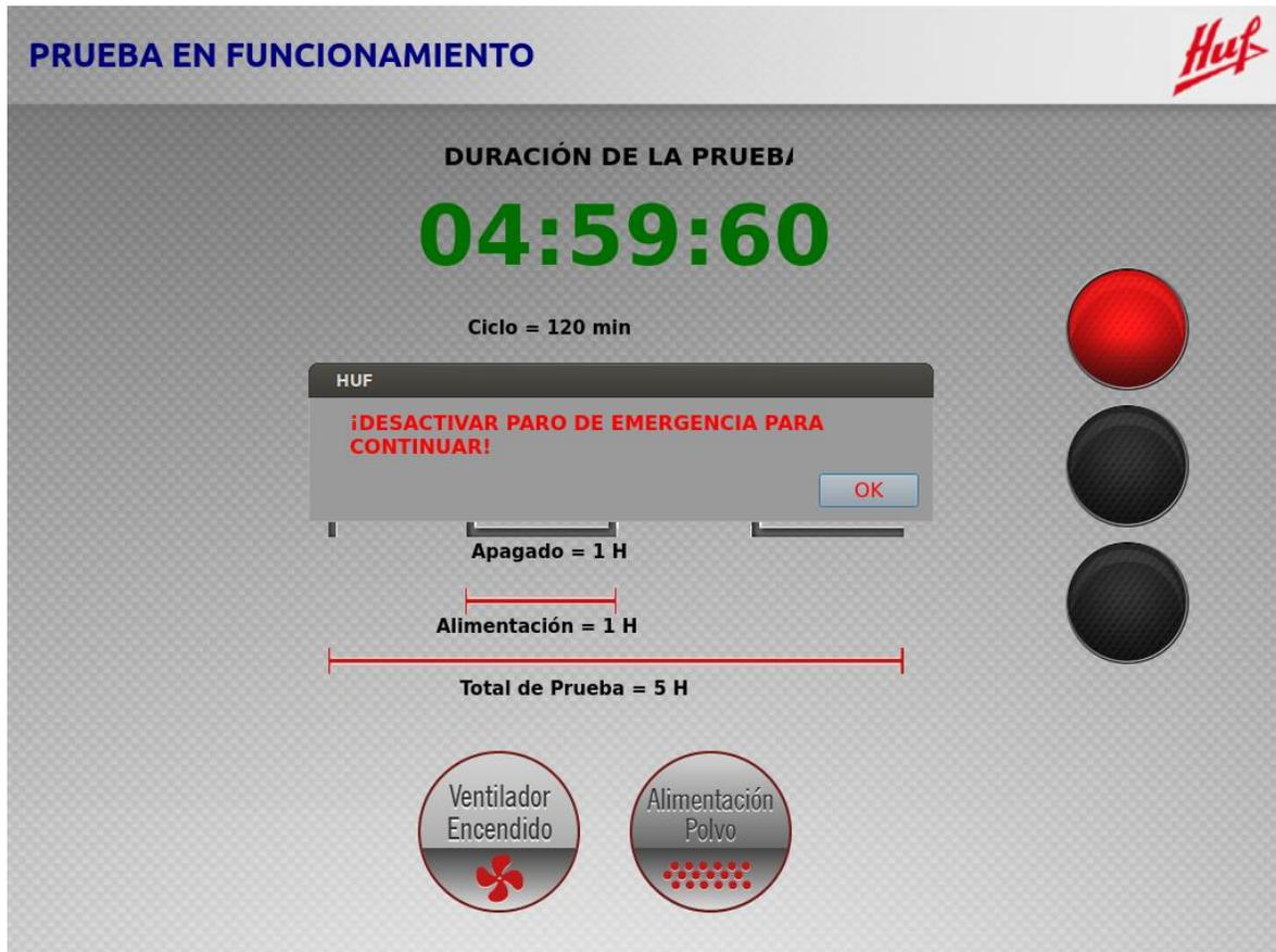
Figura 16. Mensaje que se muestra cuando el “paro de emergencia” se encuentra activado.
