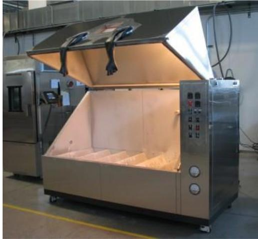
**Figura 1.4** Cámaras de asentamiento de polvo ESPEC.
