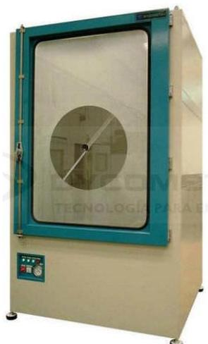
**Figura 1.3** Cámara de prueba de estanqueidad al polvo EDC Series.
