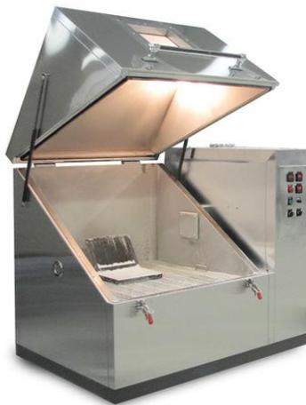
**Figura 1.5** Cámara de asentamiento de polvo ESPEC EDC.
